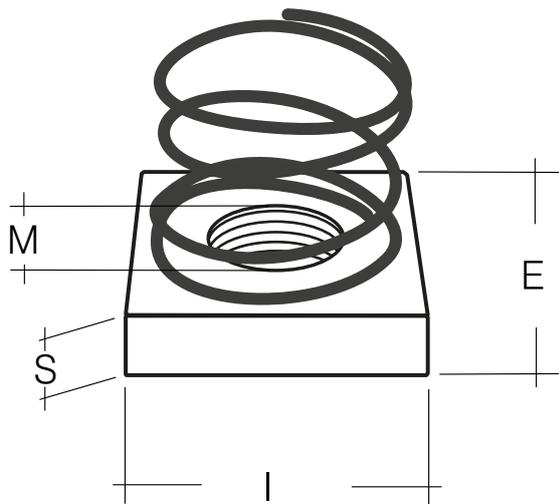
Dado quadro con molla di ritegno per posizionamento e registrazione fissaggi in barre profilate a C 20 X 32
