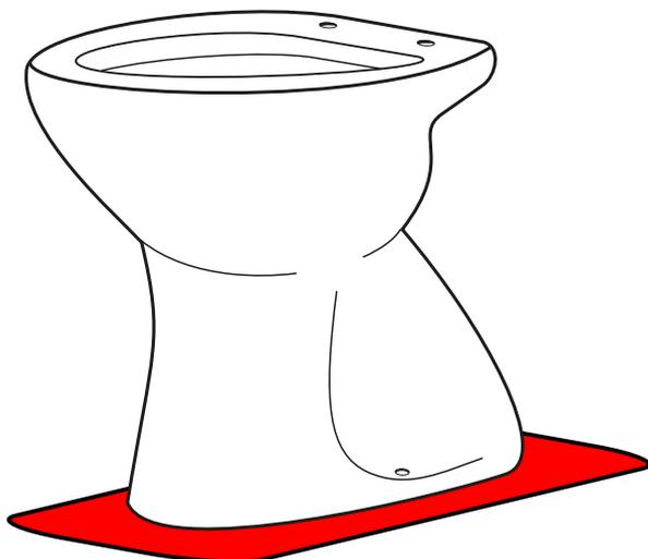
La protezione antiurto acustica per vaso e bidet a pavimento in fase di montaggio, evita di scheggiare o rompere il manufatto e le piastrelle.
