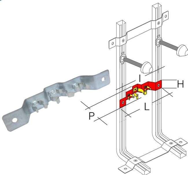
Kit di posizionamento tubi bidet induzione e scarico per staffe ad «L» di interasse 180mm e con profilo da 26 a 35mm di larghezza
