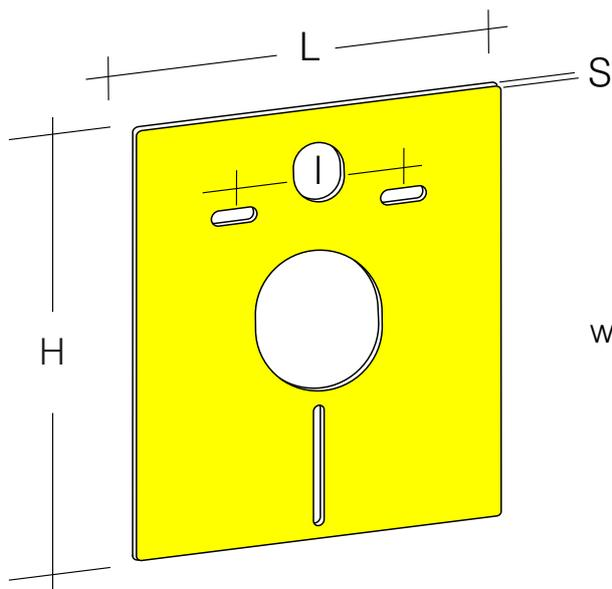
Protezione specifica antiurto e acustica rettangolare da 2 mm ad alta densità per wc e bidet sospesi a fissaggio nascosto dal basso e laterale
