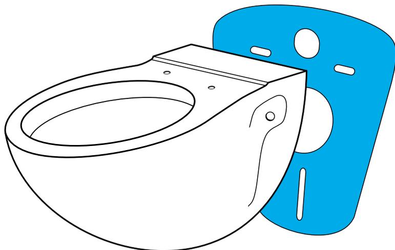
La protezione antiurto acustica per vaso e bidet sospeso in fase di montaggio, evita di scheggiare o rompere il manufatto e le piastrelle.
