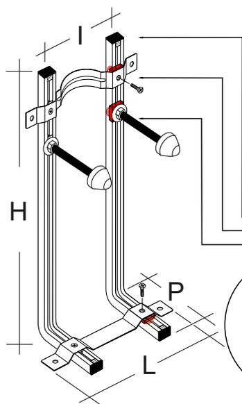
Staffa a L per vasi e bidet sospesi a montaggio rapido Speedyfix e tappi di copertura antinfortunistica in scatola di montaggio e/o preassemblata
