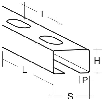
Profilo a C ottimizzato in acciaio zincato da 2 mm di spessore con fori ad asola 20 x 9 mm interasse 50 mm
