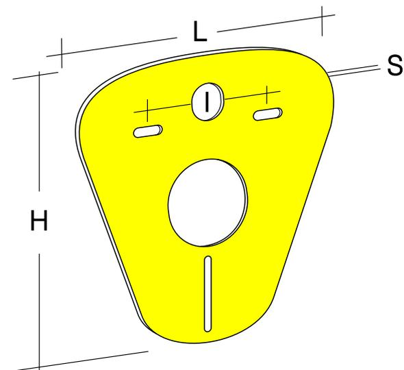
Protezione specifica antiurto e acustica sagomata universale da 2 mm ad alta densità per wc e bidet sospesi a fissaggio nascosto dal basso e laterale
